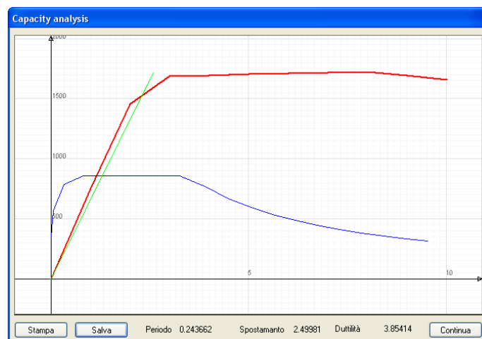
Spettri demand (blu) e capacity (rosso). In verde il periodo proprio della struttura a un grado di libertà
