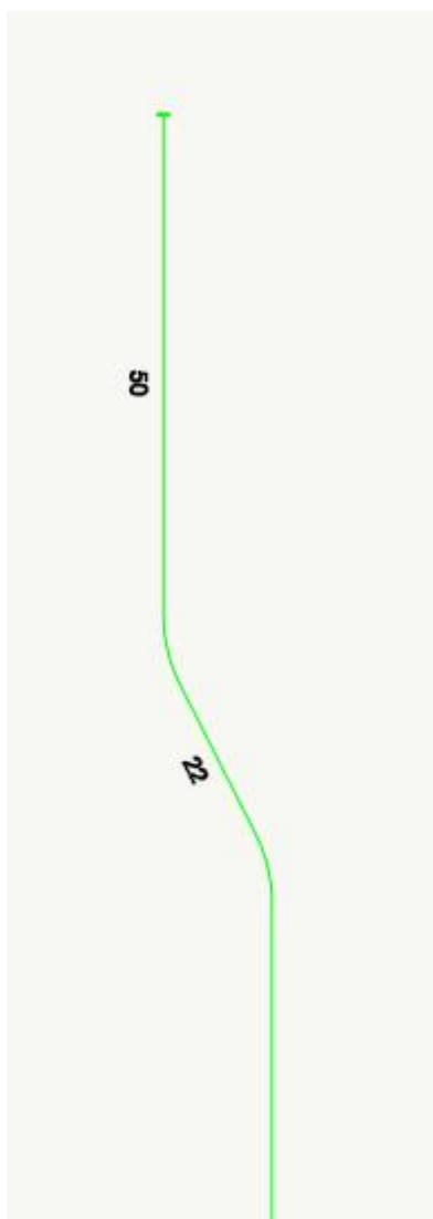
Con questa dizione, in effetti poco intuitiva, si intende la quantità massima della quale si accetta che le barre possano essere sagomate formando uno spostamento laterale dell'asse, per creare una continuità con le barre del pilastro superiore qualora tale pilastro, risegando, abbia barre non in asse con quelle del pilastro sottostante. Infatti questa opzione è applicabile solo a pilastri.
