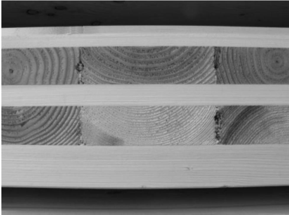
Figura 3.3- Sezione di pannello di Xlam a 5 strati. [12]
